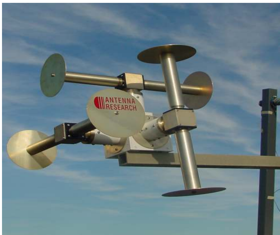
איור 6 אנטנה איזוטרופית כגון 3 דיפולים ניצבים (American Research Antennas) ניתן לאפיין ע"י שלושה חתכים (xy, xz, zy) ובשני קיטובים
